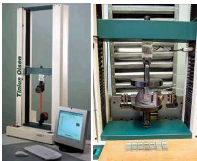
Рисунок 25 – Разрывная машина Tinius Olsen H10КТ общий вид (слева), положение образца в упорном приспособлении (справа)
