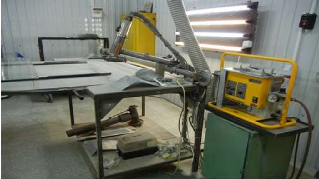
Рисунок 37 – Внешний вид установки нанесения шинок на стекло газодинамическим методом
