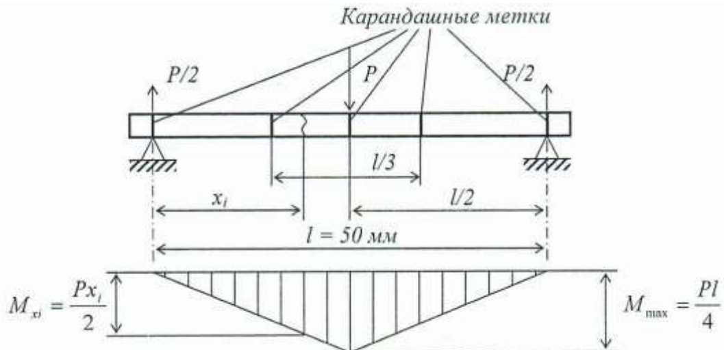
Рисунок 19 – Схема нагружения и эпюра изгибающего момента образца
